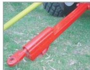
• LANZA ARTICULADA Equipada con 2 resortes compensadores y rótula de nivelación
