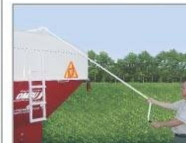
• COBERTURA DE LONA (Opcional) Operación de apertura de la cobertura de lona desde el piso.
